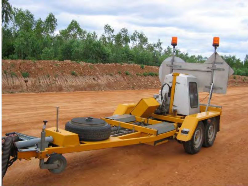
ภาพที่ 8 ภาพแสดงอุปกรณ์ Falling Deflectometer (FWD) ในระหว่างการทดสอบชั้นพื้นทางดินซีเมนต์ โครงการก่อสร้างทางหลวงหมายเลข 3510
